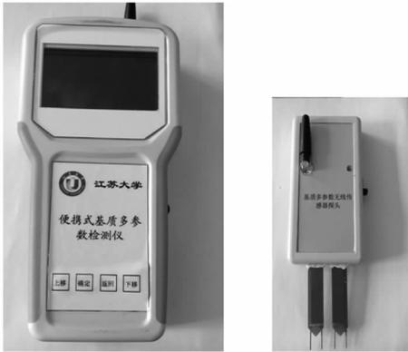
图 10 便携式基质多参数无线检测仪
