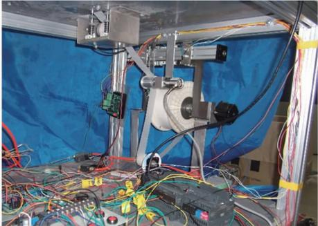
图13 定向种子带自适应模糊PID恒张力控制试验台
