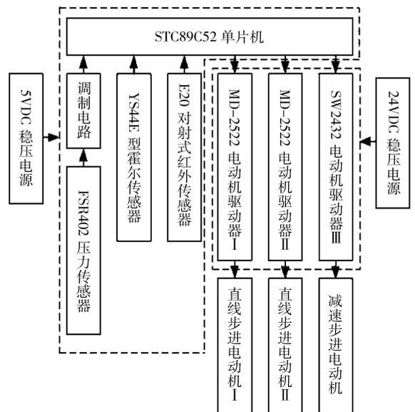
图 6 控制系统结构图
