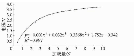
图7 电压与加载量的关系
