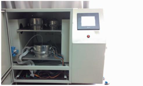
图1 电子鼻系统实物图
