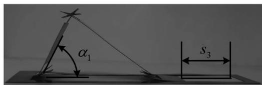
图12 平面折展滑块机构的展开状态实物主视图
