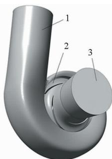
图5 混流泵全流道计算域
