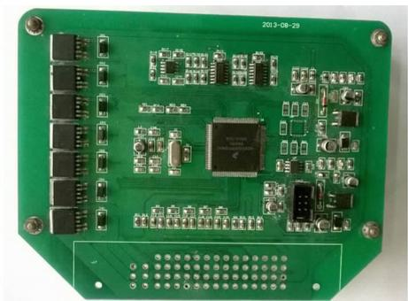
图2 电控空气悬架用电子控制单元
