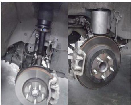
图1 改装后的试验车辆的前悬架、后悬架
