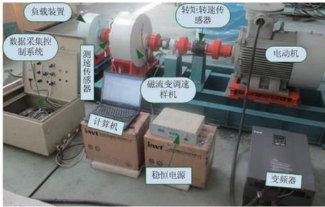
图8 磁流变调速起动试验台
