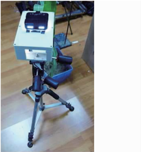
图 2 采集装置实际照片 Fig. 2 Leaf color acquisition device
