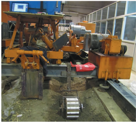
图8 土槽台车测试系统
