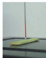
图4 油菜茎秆的接触角测量
