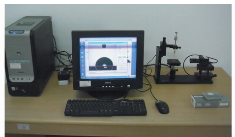
图1 CAM101型接触角测量仪
