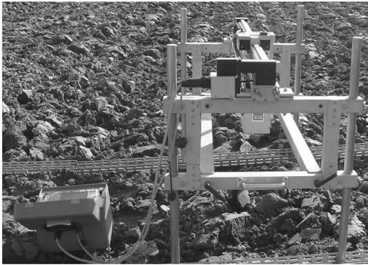
图2 激光不平度测试仪
