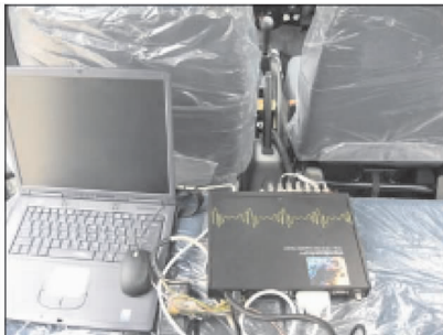
图 11 数据采集装置 WAVEBOOK Fig. 11 Data acquisition unit WAVEBOOK
