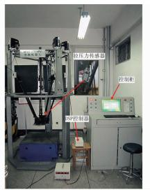
图 5 冗余驱动 6PUS - UPU 并联机器人
