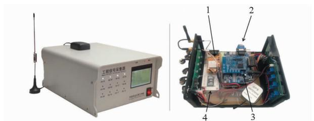
图6 数据采集器硬件实物图
