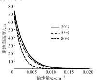
图 6 风洞中心风速为 11 m/s 时不同植被盖度 草地输沙量拟合曲线
