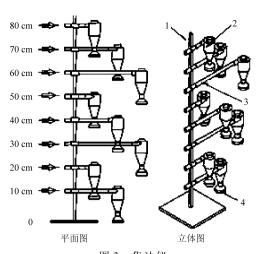
图 3 集沙仪 Fig. 3 Sand sampler
