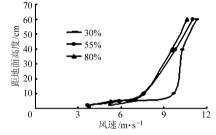
图 5 风速 11 m/s 时不同植被盖度的风速廓线
