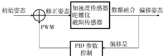
图3 闭环控制结构框图
