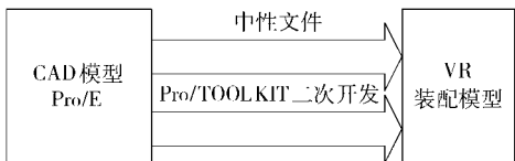
图 4 CAD 系统和装配系统数据转换示意图
