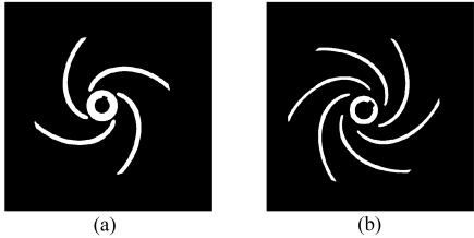
图 4 灰度变换后的图像 Fig. 4 ICT images after gray transformation (a) 1 号叶轮 (b) 2 号叶轮
