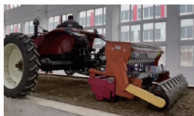
图 10 土槽试验平台
