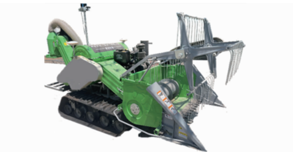
图2 轻简型电动稻麦收获机实物图
