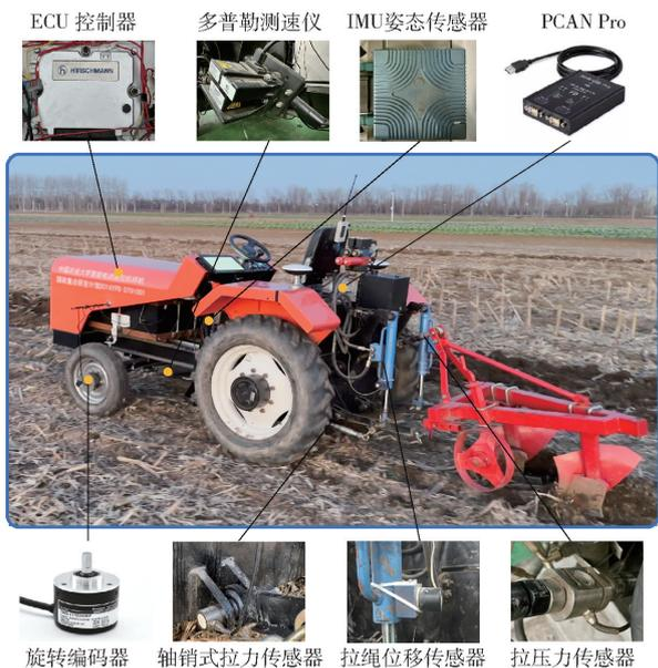
图 1 多源工况参数测试系统传感器布置图
