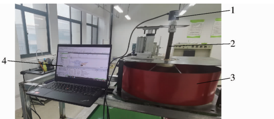
图 8 编码器安装示意图
