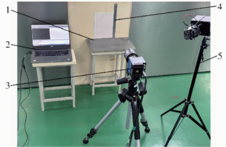
图5 碰撞恢复系数测量试验装置
