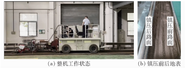
图 18 台架试验过程
