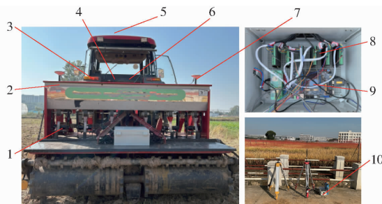
图1 宽苗带小麦播种机多行匀播分控系统总体构成图
