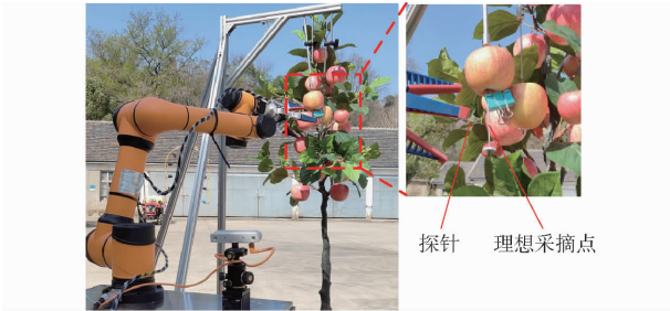
图 15 理想采摘点位置测量 Fig. 15 Measuring position coordinates of desired picking point
