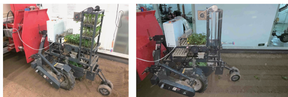
图13 高速移栽机同步接苗试验
