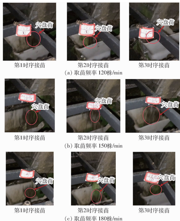
图14 不同频率下同步接苗状态
