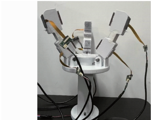
图 5 搭载视触觉传感器的采摘末端手样机
