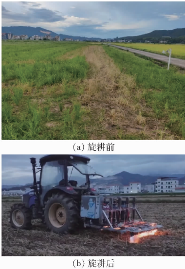
图 14 田间火焰热力消杀试验
