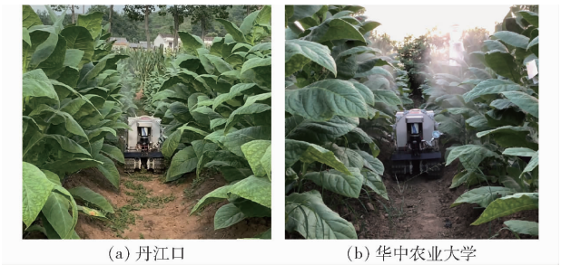
图 14 遥控自走式雪茄植株中下层烟叶植保喷雾机田间试验
