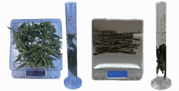
图 3 茶叶及茶梗密度测量 Fig. 3 Measurement of density
