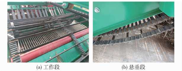
图 4 双筛式薯杂分离装置实物图 Fig. 4 Physical images of double sieve potato impurity separation device
