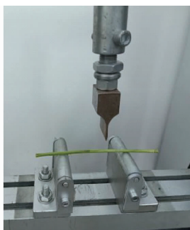
图 7 苜蓿茎秆剪切试验
