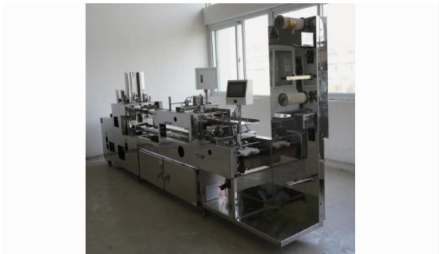
图 3 海苔片热压粘合机实物图
