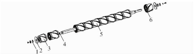
图 5 去土辊结构图 Fig. 5 Structure drawing of desliming roller
