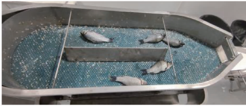
图 13 鱼体在振动台上的定向试验过程
