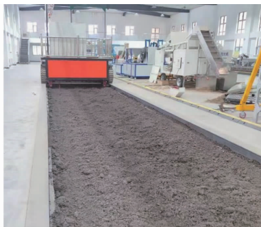
图4 室内土槽试验平台
