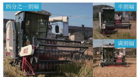
图 2 联合收获机田间不同割幅设置
