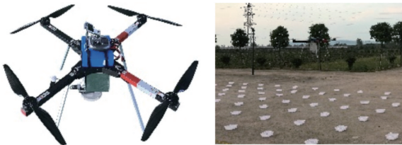
图10 无人机绿肥撒播装置场地试验
