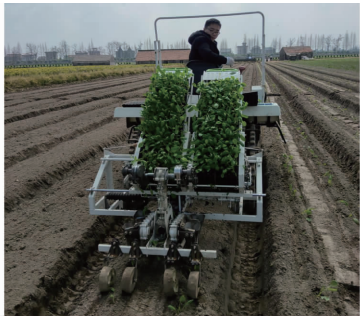
图 8 两行乘坐式自动旱地移栽机
