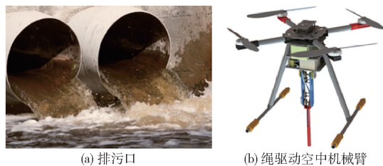
图 1 水质采样空中机械臂样机
