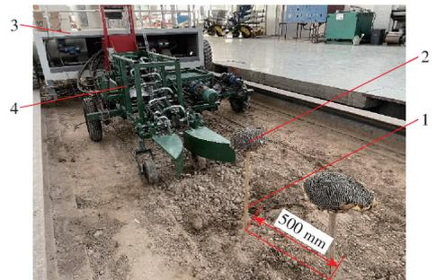
图11 食葵取盘装置土槽试验
