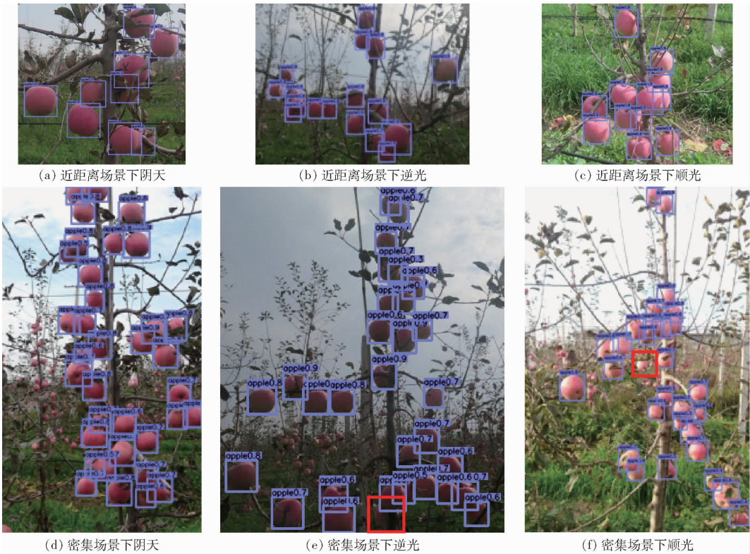
图 6 基于 Tiny Hourglass - 24 的 CenterNet 识别结果
