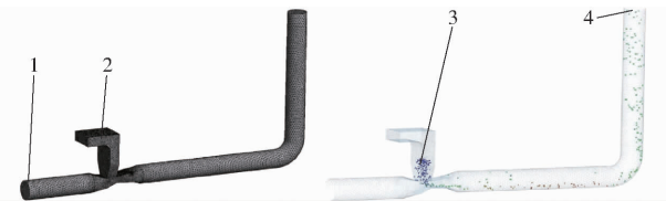
图 9 混种部件仿真模型 Fig.9 Simulation model of mixing component 1. 输送气流入口 2. 供种装置气流场 3. 种子入口 4. 输送气流和种子出口
