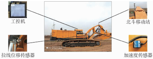
图3 高程控制系统组成
