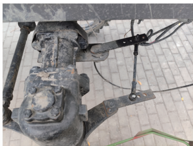
图2 前轮转角传感器安装位置
