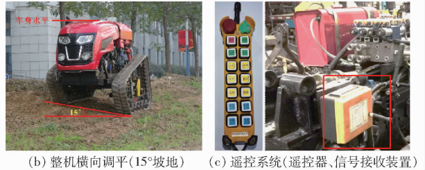
图 3 遥控全向调平山地拖拉机 Fig. 3 Remote control omnidirectional leveling hillside tractor 1. 蓄电池 2. 液压油箱 3. 冷却器 4. 发动机 5. 变速箱 6. 油箱 7. 液压系统 8. 遥控信号接收装置 9. 坡地适应液压悬挂装置 10. 驱动轮 11. 上层车架 12. 下层车架 13. 从连杆 14. 台车架 15. 拉杆 16. 液压张紧装置 17. 支重轮 18. 主连杆 19. 张紧油缸 20. 履带 21. 导向轮
