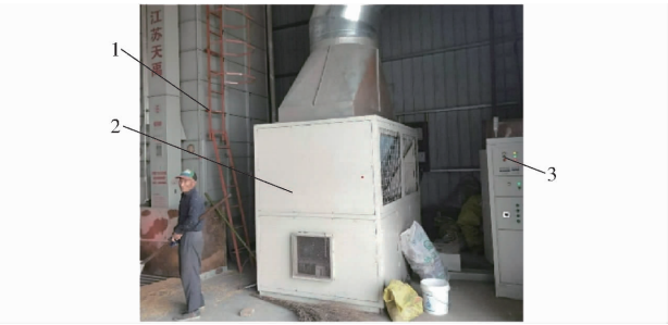
图 7 热泵式低温循环谷物干燥机试验现场
