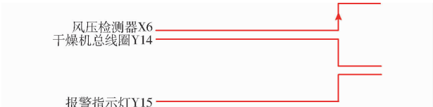
图11 紧急报警功能时序图
