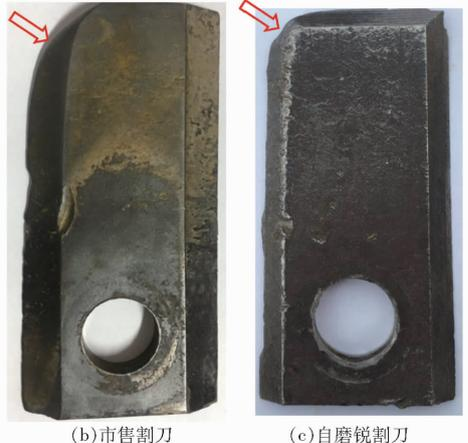
图8 两种割刀磨损失重速率曲线及作业16 h后宏观形貌对比
